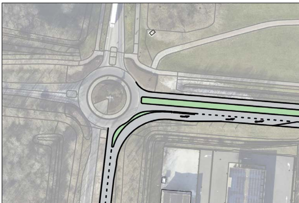
Figuur 4.5: Schematische weergave van de rotonde inclusief bypass voor verkeer vanaf de A7 richting de Oosterterpweg
